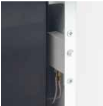
microswitch di sicurezza sull'apertura del box
