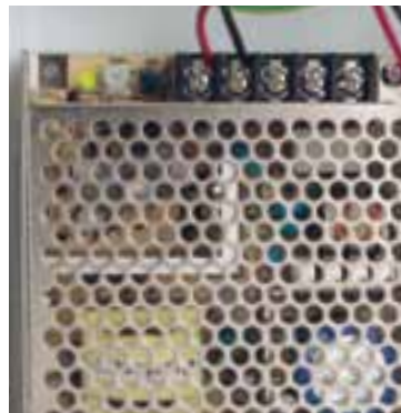
alimentatore switching 1,7 o 3 A
